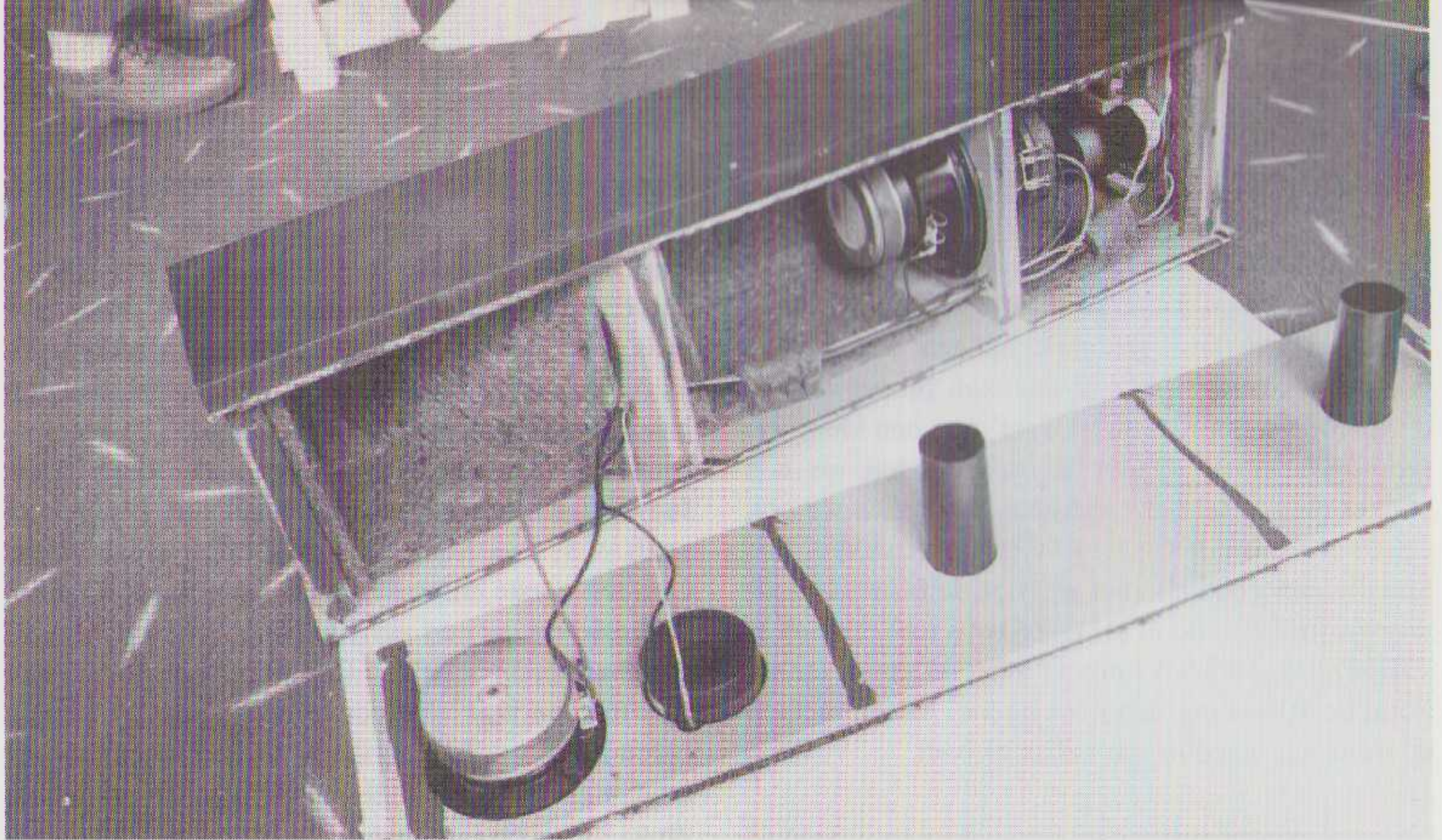
In de geopende kast is te zien hoe het werkt. Een kleine en een grote basreflexkamer en een aparte kamer voor de middenunit.
